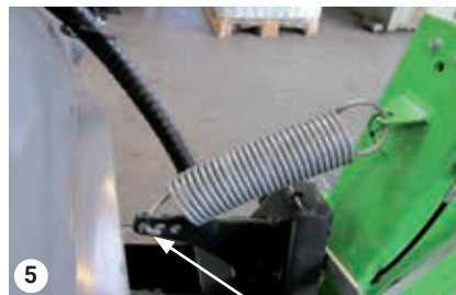
Zaháknite pružinu do otvoru na konzole
