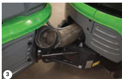
Hadicu vyčistite na kĺbovom spoji
