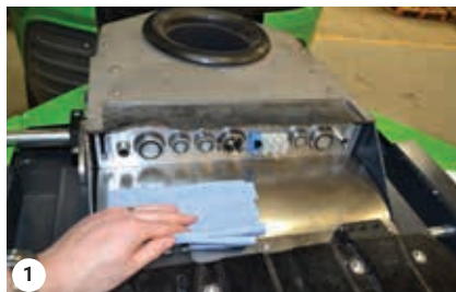
Západkové spojky očistite handričkou
