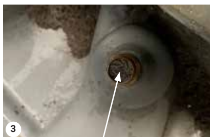
Vyčistite oceľový filter na vákuu
