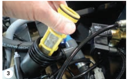
3 Filter vyčistite alebo vymeňte
