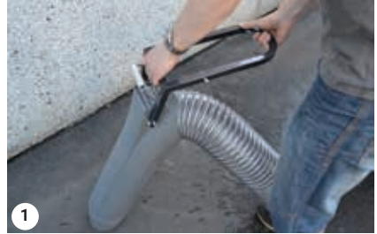
Na čistenie systému použite externú hadicu
