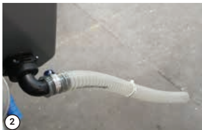
Hadica hladiny vody v nádrži na odpad
