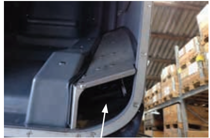
Odstráňte poklop na každom filtri
