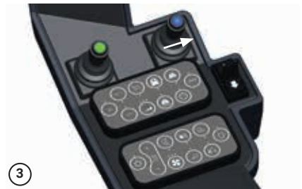
Otváčajte a nakláňajte pravú kefu smerom von
