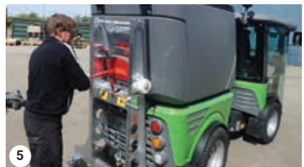
5 Zatlačte rám príslušenstva a uistite sa, že háky sú na svojom mieste vo zdvíhacích zariadeniach.
