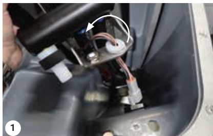
1 Otočte nabok a vyťahnite. Otvor konektora
