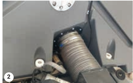
Odpojte externú hadicu uvoľnením hadicovej svorky
