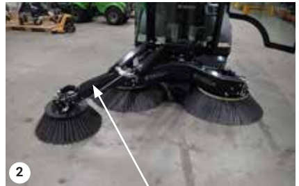
2 Odstráňte kryt (kefa vo vysunutej polohe von)
