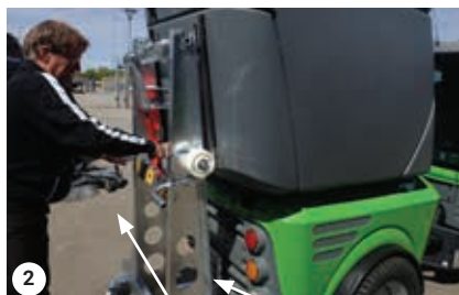
Znížte násypku na rám nosičom západkového mechanizmu.
