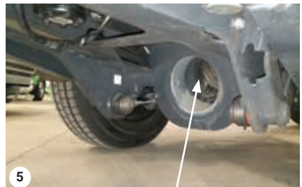
Vyčistite výstupný systém potrubia na ráme A stroja
