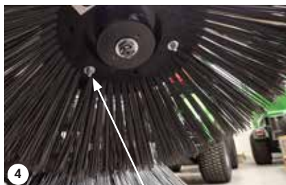
Uvoľnite 3 matice a vymeňte kefu
