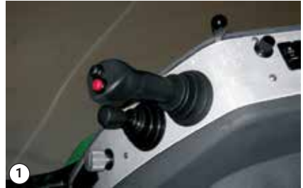
1 Rovná radlice je zvednuta řídicí pákou
