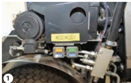
Generátor 60 A JF15 – Poistková skriňa napájania 60 A JF1 Núdzové vedenie 20 A JF2 – výkon motora 30 A JF3
