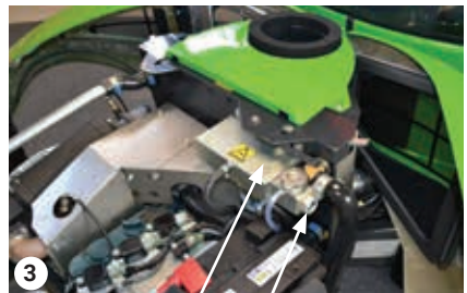
Vyrovnávacia nádrž - kontrola chladiacej kvapaliny
