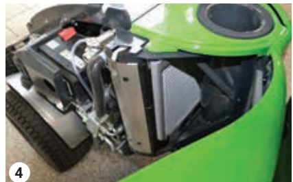
Vyčistite chladič pomocou stlačeného vzduchu
